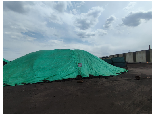
原料堆场 (苫盖+围挡)
